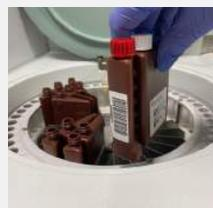
**Carga contínua:** versatilidade para carga contínua de amostras e manejo de urgências. Carregamento contínuo de reagentes em qualquer ponto do processo
